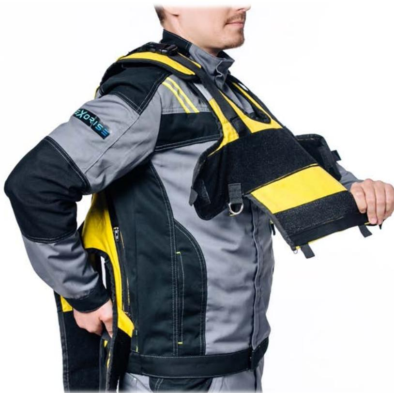
U-образный выступ опорного каркаса следует разместить на пояснице на уровне, комфортном для использования экзоскелета, и убедиться, что при данном позиционировании спинной части грудной элемент также находится на комфортном уровне. В ином случае необходимо изменить размерность экзоскелета с помощью наплечных «липучек», предварительно разъединив наплечные фастексы.
